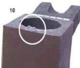
10. Deixe uma pequena porção do pó mais fino na borda do molde, para servir de rastilho para a ignição.
