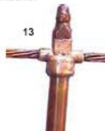
13. As temperaturas atingidas podem exceder os 2200°C. Aguarde tempo suficiente para o resfriamento antes de tocar as partes soldadas.
