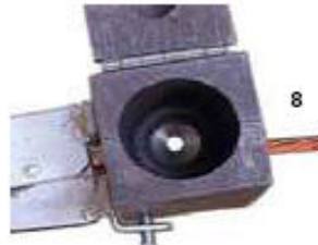
8. Certifique-se que o disco fique com a parte côncava para cima.
